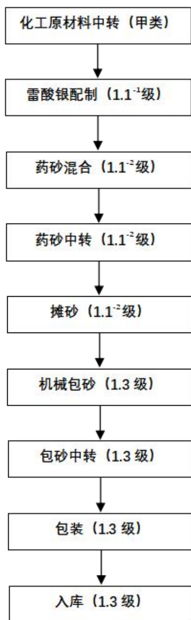
图 C. 40 玩具类（摩擦型/砂炮）生产工艺流程图
